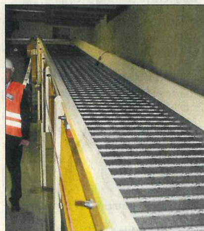
Im Schrottkanal landet das Blech, das beim Pressen abgetrennt wird.
